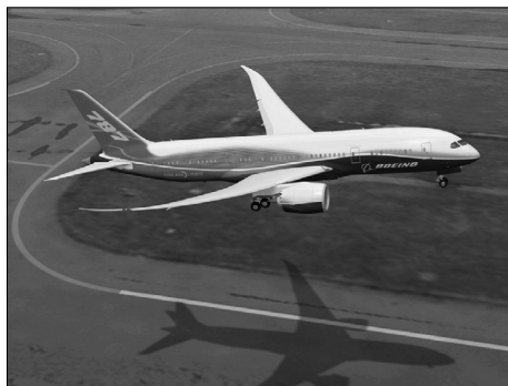
Boeing 787 – “phi cơ giấc mơ” của Hãng Boeing, chiếc máy bay lớn đầu tiên sử dụng vật liệu composite cho phần lớn cấu trúc của nó, dự kiến đưa vào khai thác năm 2008
