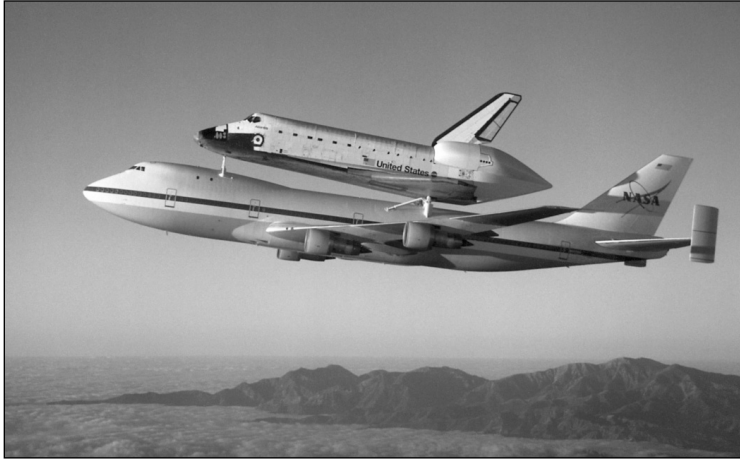
Một chiếc Boeing 747 được NASA sử dụng để “cống” và “phóng” tàu con thoi vào không gian
